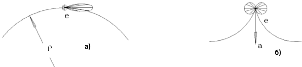
Рис. 1. Угловые диаграммы направленности излучения циркулярно движущегося заряда а) в лабораторной системе, б) в мгновенно сопутствующей системе отсчета.
