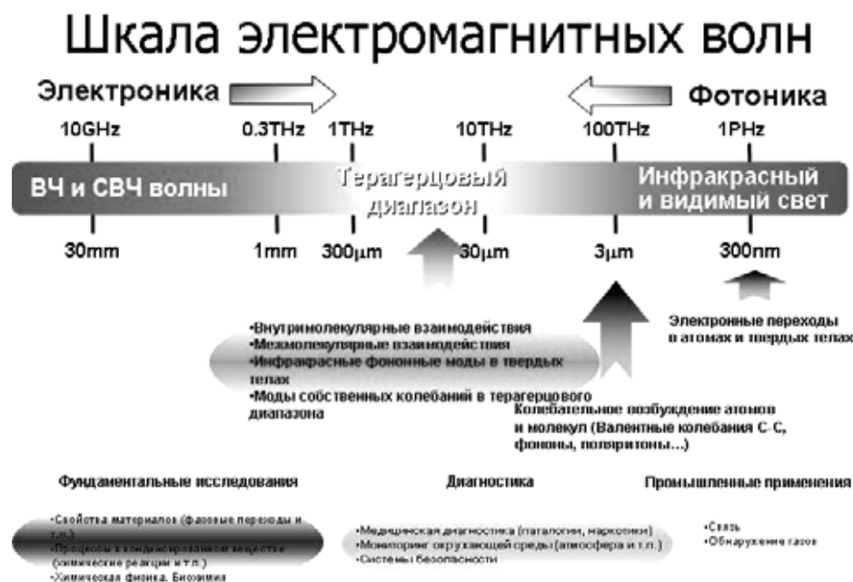
Рис. 1. Положение терагерцового диапазона на шкале электромагнитных волн и приложения, в которых использование терагерцового излучения открывает новые возможности
